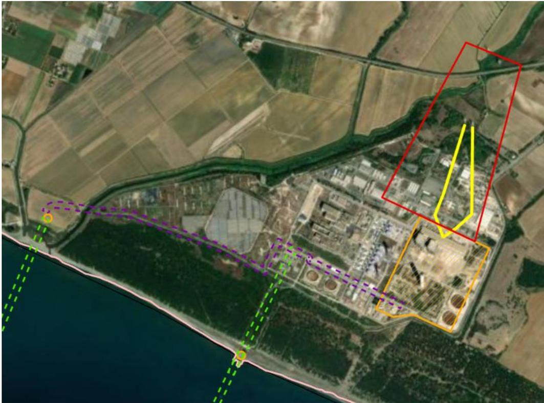
Figura 6-6: Ipotesi localizzative fasce di fattibilità preferenziale ed alternative tracciati terrestri dei cavi HVDC e fascia di fattibilità raccordi aerei HVAC, lato Lazio – Comune di Montalto di Castro (per la legenda si rimanda alla figura 6-1)
